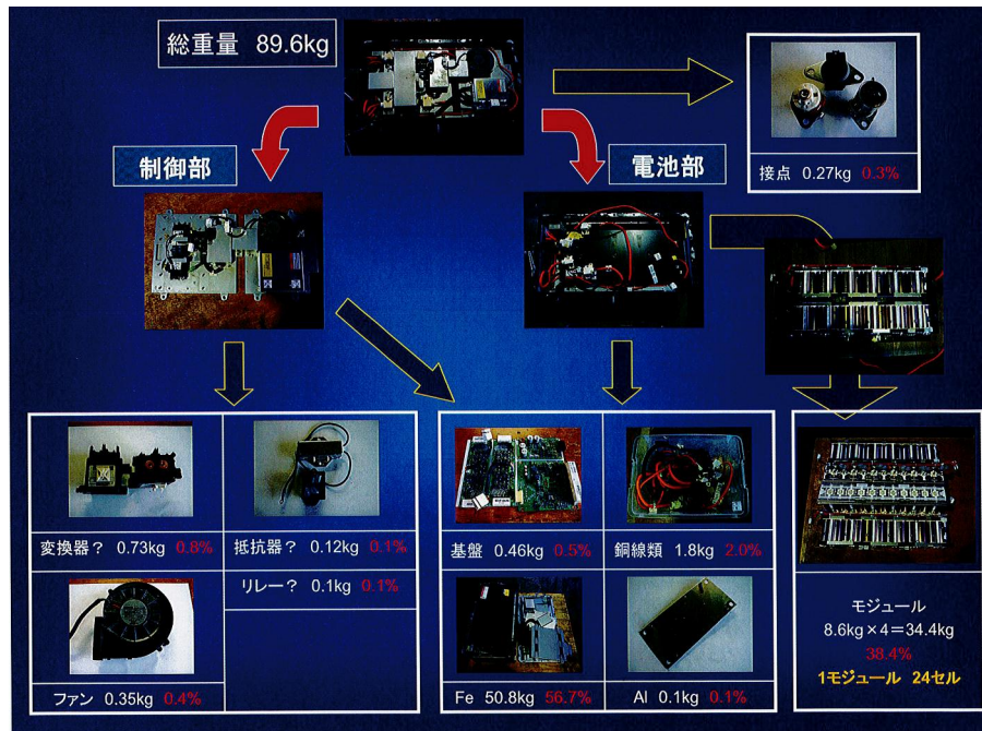
自動車用Li 電池デバイスの解体フロー
